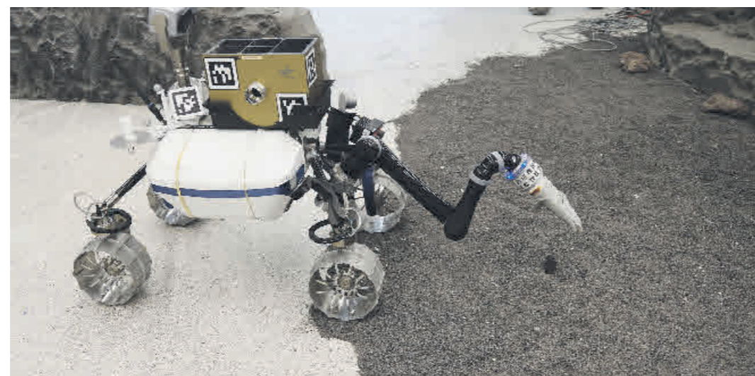
Einsiger Sammler: Der Roboter LRU 2 sammelt mit seinem Greifarm Steine und nimmt entlang seines Wegs Sandproben auf dem Testfeld ... Foto: Rudolf Stumberger
